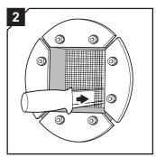
Разрежьте сетку ножом или проткните пальцами, чтобы проложить кабели/трубы.
