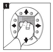
Слегка смажьте муфту снаружи и обильно внутри, особенно с углах, используя Roxtec Lubricant. Очистите от загрязнений гильзу/ монтажное отверстие. Отодвиньте в стороны наружные накладки муфты.
