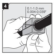
Добейтесь зазора 0,1-1 мм между половинами модуля, сжав ими кабель/трубу.
