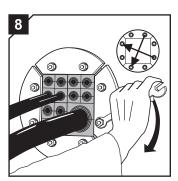
Закрутите гайки равномерно, в перекрестном порядке. Муфта будет сдавливаться до полного уплотнения.
