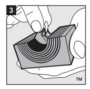
Подгоните внутренний диаметр модулей под диаметр уплотняемых кабелей или труб, удаляя слои резины.
