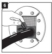
Вставьте модули в муфту согласно плану размещения.
